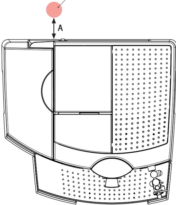
**i** Mindestabstand (A) der Bohrung zum Gerät: 40 mm
